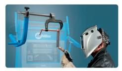
**Bras de positionnement de soudage** permettant l'apprentissage pour les applications GMAW, FCAW et SMAW hors position.
