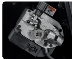
**Accionamiento de alambre en ángulo resistente con rodillo de accionamiento Quick Select™** para cambiar con facilidad de un tipo/diámetro de alambre a otro. El rodillo de accionamiento Quick Select ofrece tres ranuras: dos para alambres macizos de diferentes tamaños y una tercera para alambres con núcleo de fundente.
